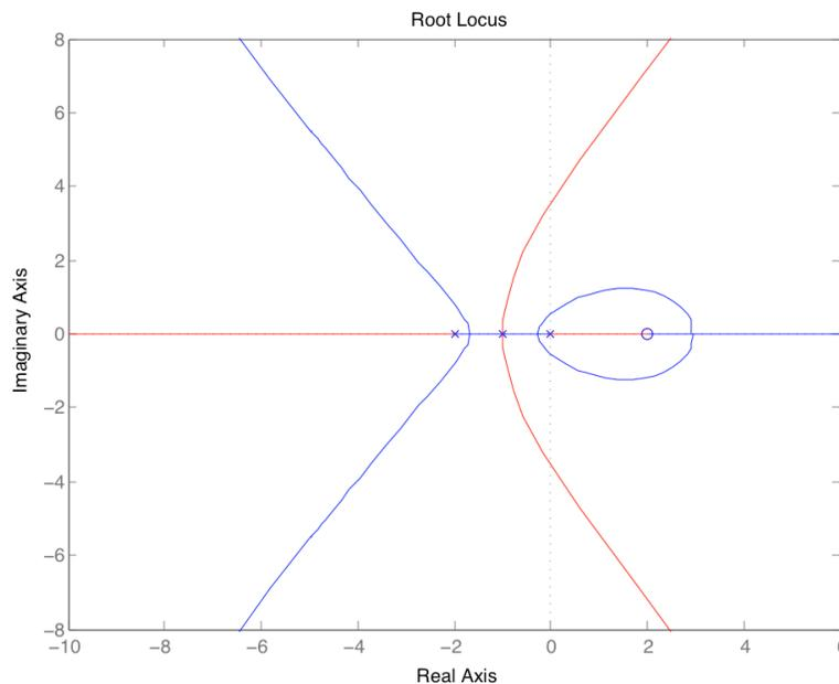
Per verificare tale circostanza e determinare il valore di  $k^*$ , è sufficiente applicare il criterio di Routh al denominatore della funzione di trasferimento ad anello chiuso, ovvero  $s^4 + 4s^3 + 5s^2 + (2+k)s - 2k$ . Si trova, come previsto, che il sistema è asintoticamente stabile per  $-0.73 < k < 0$ . Il controllore richiesto è dunque
