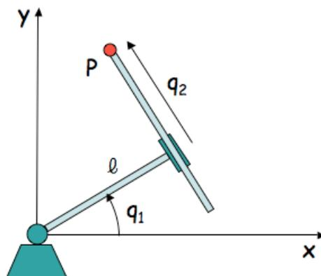
Si consideri il robot planare RP in figura, dove  $\ell$  è la lunghezza del primo braccio e sono indicate le coordinate generalizzate da utilizzare. Sia  $\mathbf{p} = (p_x \ p_y)^T$  la posizione dell'organo terminale  $P$ .
