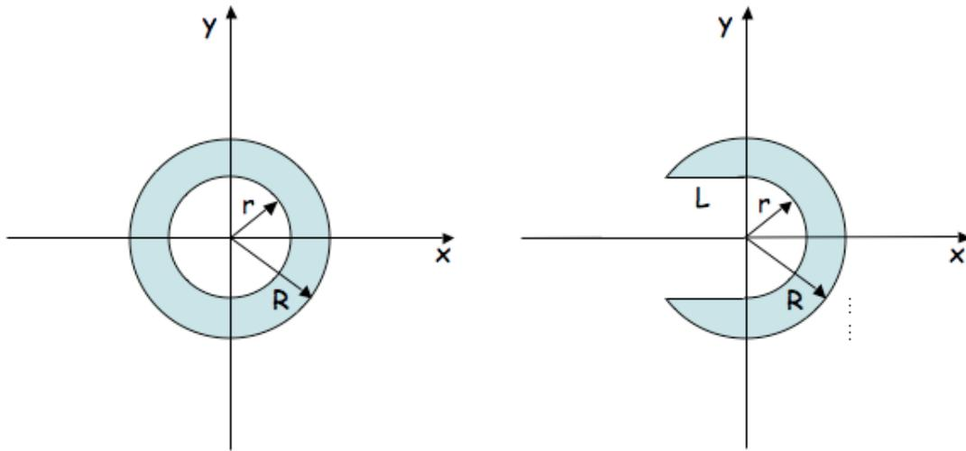
Figura 1: Spazio di lavoro, dove  $r = \ell$ ,  $R = \sqrt{\ell^2 + L^2}$ ; a sinistra il caso con solo  $|q_2| \leq L$ ; a destra il caso completo, anche con  $|q_1| \leq \pi/2$
