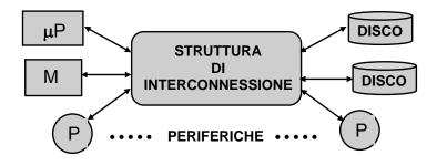
La struttura di interconnessione assicura la comunicazione fra le diverse componenti dell'elaboratore
